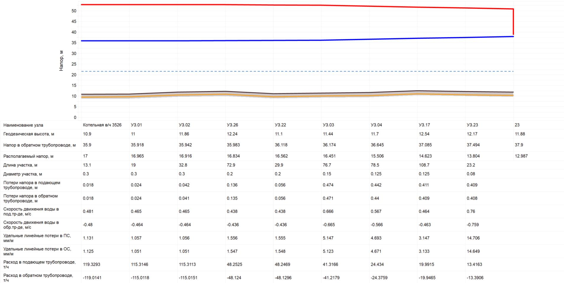
**Рисунок 1.10. Пьезометрический график от котельной в/ч 3526**
